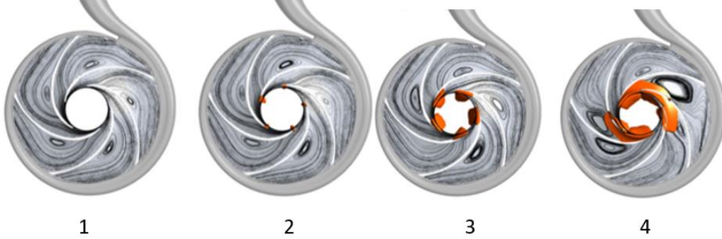
الشكل (6) يبين بداية حدوث التجاويف في الدفاعة حول الريش
